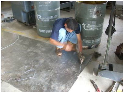
Cortando lamina para el cono
